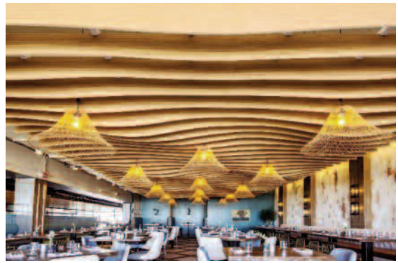
Dòng vách cách âm Atmosphera của Arktura có hình dạng như sóng lượn và được làm từ vật liệu SoftSound giúp hấp thụ tiếng ồn.
