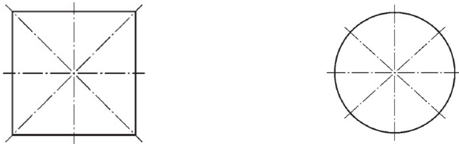
a) Vị trí đầu đo ở hai đầu mẫu lăng trụ và mẫu trụ
