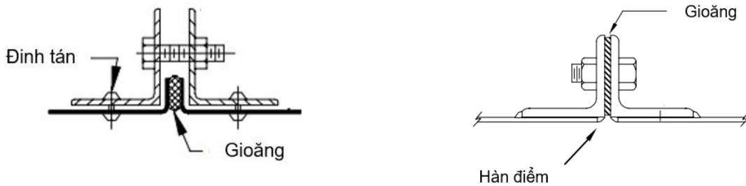
Hình 2 - Liên kết mặt bích với ống gió
