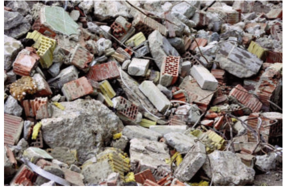
Bê tông vụn, gạch vỡ sau phá dỡ công trình có thể thu gom, tái chế để tái sử dụng làm vật liệu san lấp, làm đường, xây dựng
