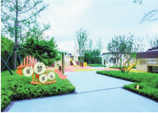
Công viên dành cho trẻ em được lát đá thấm nước
